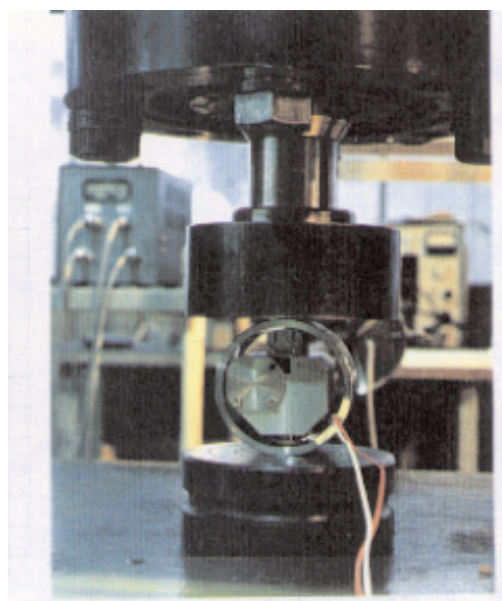
写真12 パイプによる4点マーカース実証試験全景
