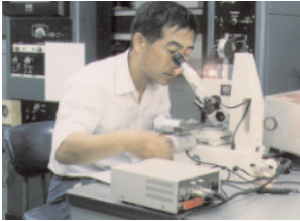
写真4 圧痕間隔測定状況
