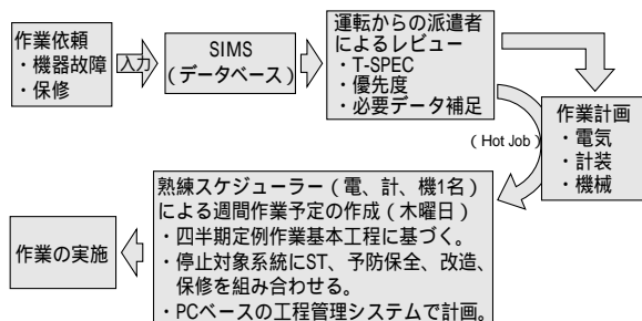
図4.4 日常保守作業の処理の流れ
