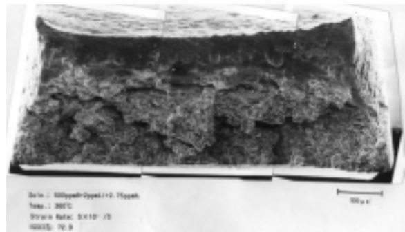
写真1 SSRT試験片の破断面SEM写真（360℃、溶存水素量2.75ppm）
