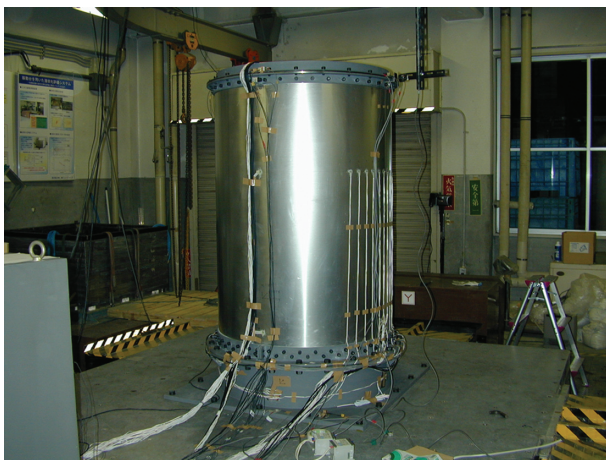
図3 振動台に設置したモデルタンクの写真
