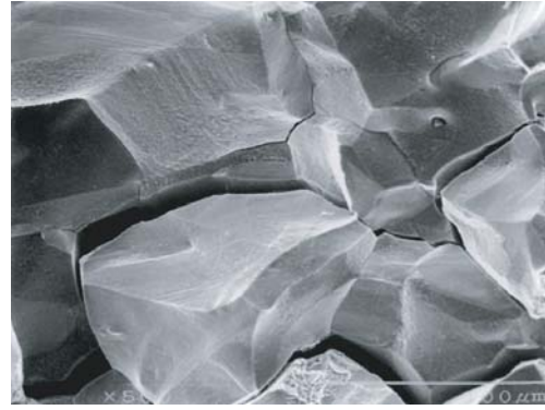
(1) 水素チャージ後の破面 SEM 像
