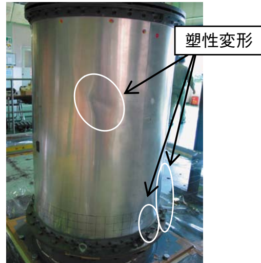
図5 座屈後のタンク試験体 (270°側)
