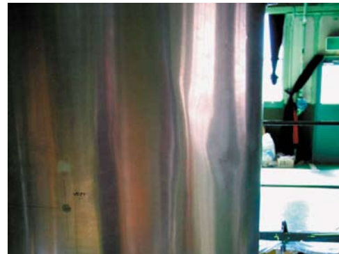
図6 タンク試験体側面の変形 (270°側)
