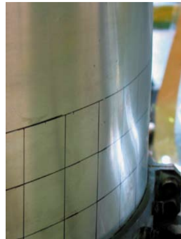
図7 タンク試験体下部の変形 (0°側)
