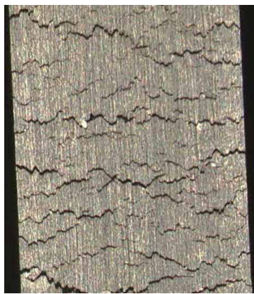
SCC き裂発生を観察 (ステンレス鋼、硫酸環境中)
