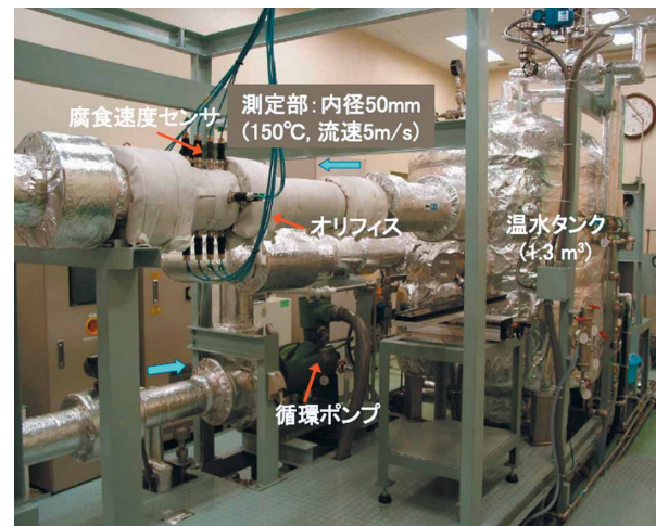
写真2 流れ加速型腐食（FAC）実験設備
