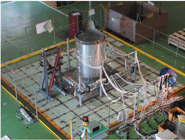
写真3 水の入ったタンク振動試験
