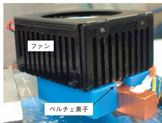
図2 コールドタッチの冷却機構
