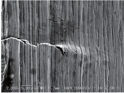
図 11 き裂先端写真例 (3次元リアルサーフェスビュー顕微鏡)
