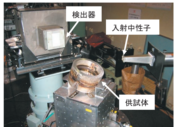
図5 RESA装置による残留応力測定の様相
