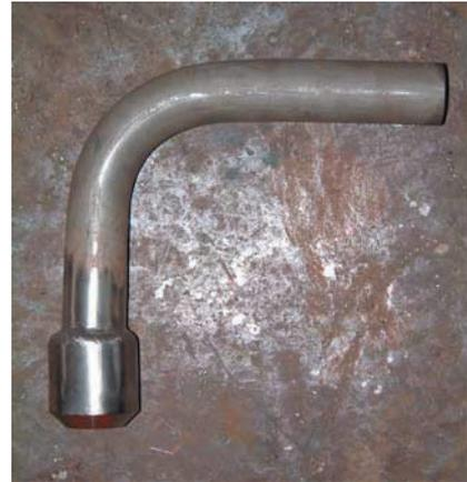
図5 試験体ソケット溶接継手部の写真
