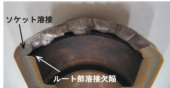
図12 破断面
