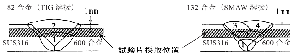
図 2 供試材溶接方法および試験片採取位置 (TIG 溶接および SMAW 溶接)
