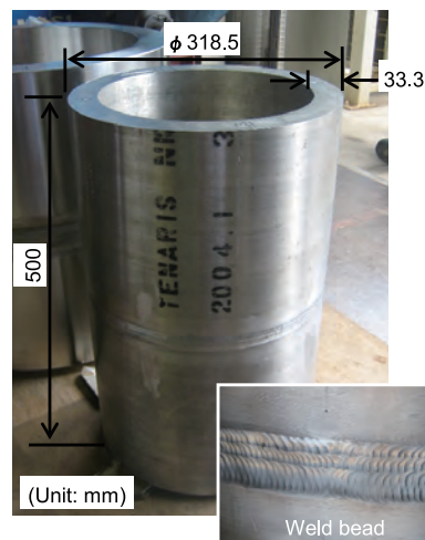
図 6 試験体の外観と溶接ビード
