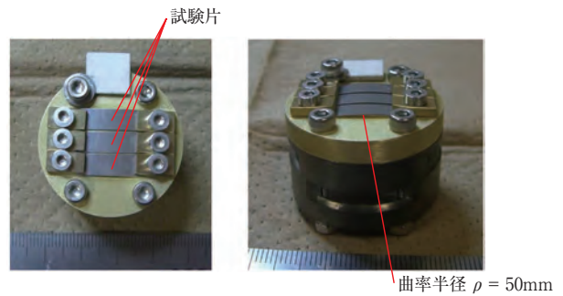
図2 曲げ照射ステージの外観
