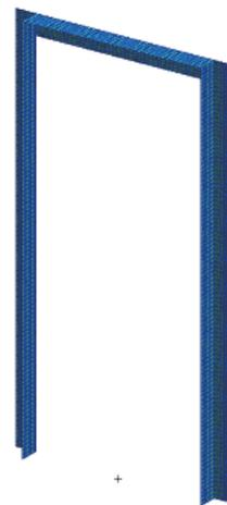
図3 門型タイプの支持構造物モデル
