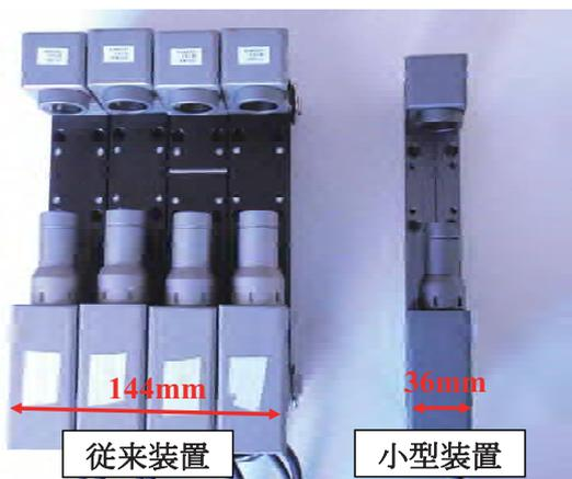
図7 従来装置と小型装置の測定部の概観比較
