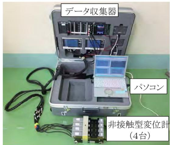
図3 振動応力測定装置(従来装置)
