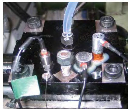
図2 軸受上部の振動センサと3種のAEセンサ
