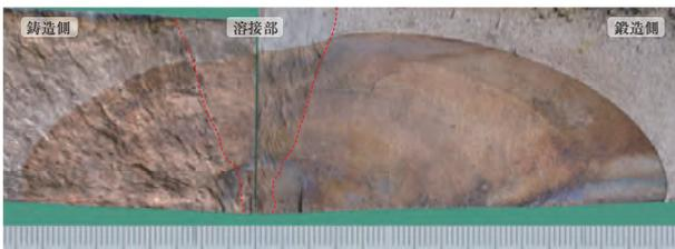
図9 疲労き裂破面 (破面開放後)
