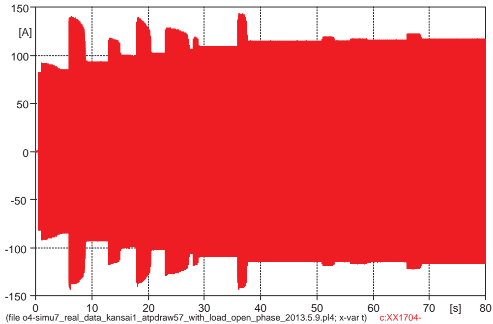
図8 変圧器外電側（入力側）の中性点電流
