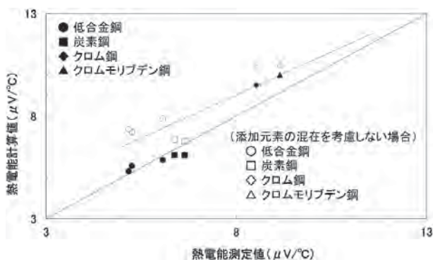
図7 実用鋼の熱電能の計算値と測定値の比較
