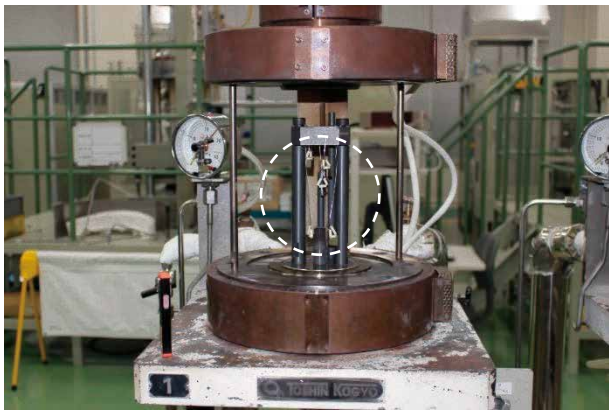
図2 試験片取付状況
