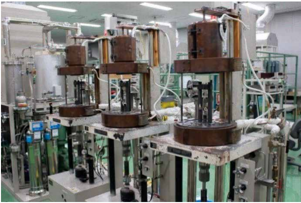
図1 No.2 SSRT 腐食試験装置外観
