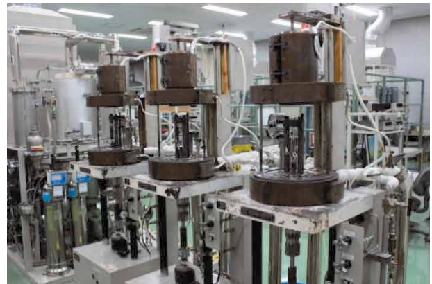
図 1 腐食試験装置外観
