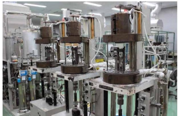
図 1 腐食試験装置外観
