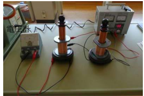
<送電システムを模擬した回路 ぎ >
