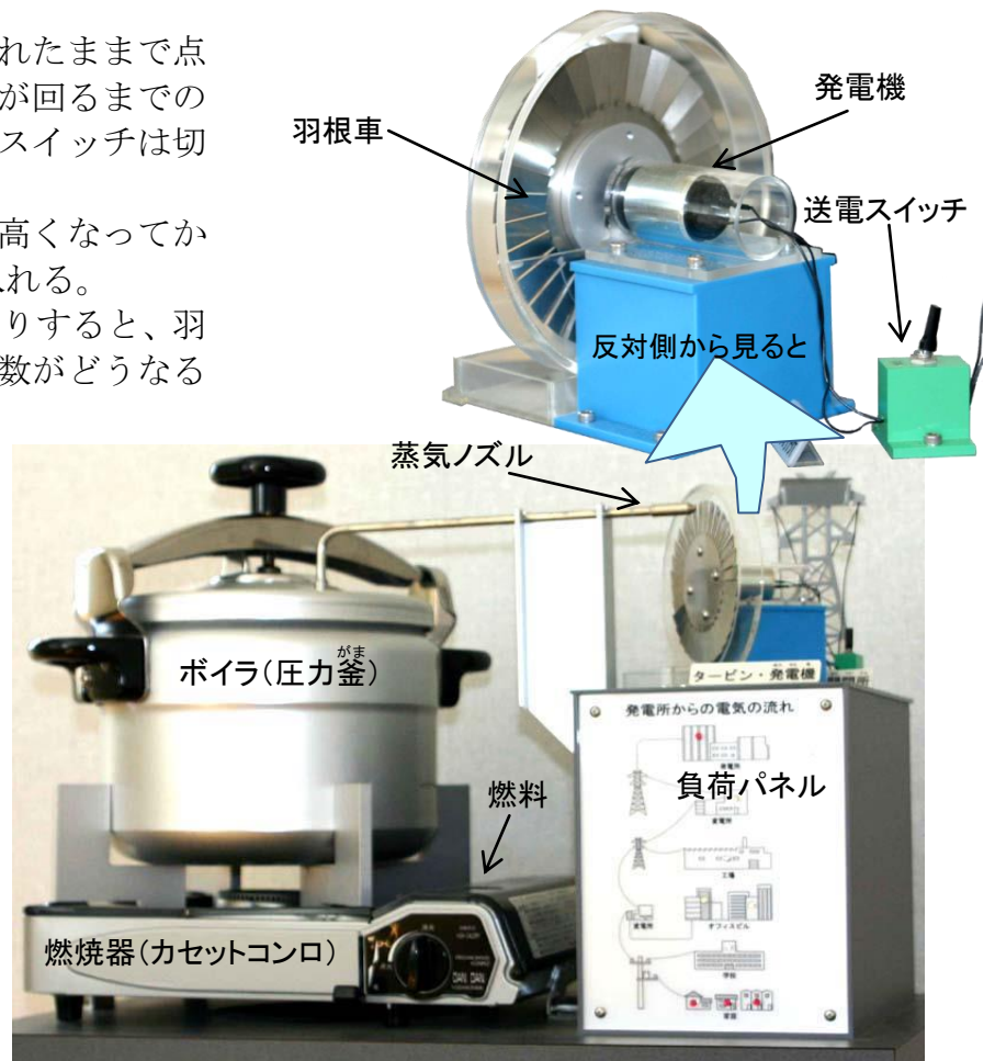
蒸気による発電実験装置
