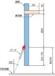
自己消火性の実証試験の例(UL垂直燃焼試験)
